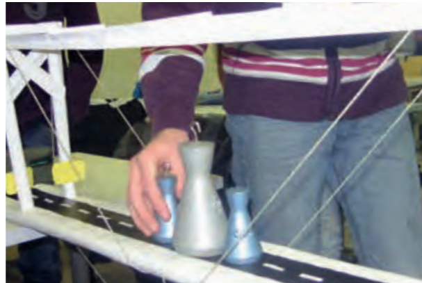
Die selbst konstruierten Brücken wurden dann mit großer Spannung einer zerstörenden Prüfung unterzogen.
